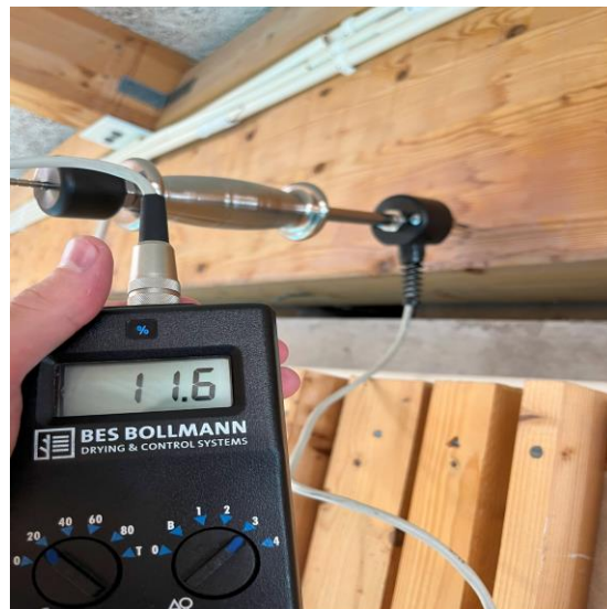
Bild 16 - Bild på fuktkvotskontroll i balk, under gränsvärde (östra sidan, vänster om lekland). Här noterades mindre misstänkt mikrobiellpåväxt & missfärgningar.
