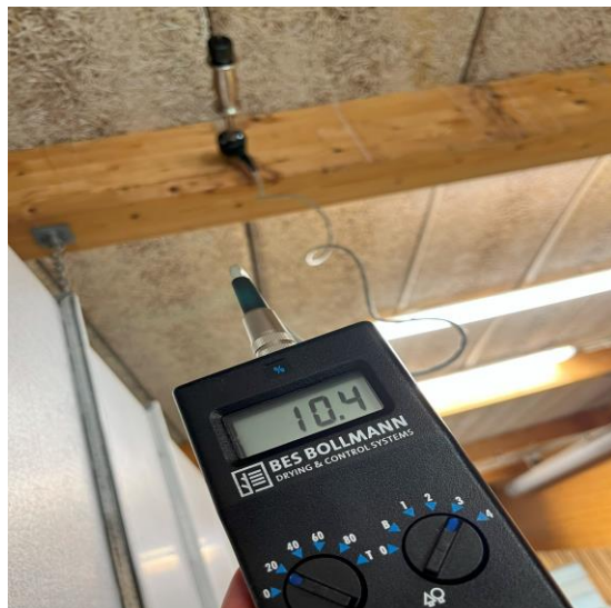
Bild 20 - Bild på fuktkvotkontroll i balk, under gränsvärde (ovanför entrésolplanet). Här noterades mindre misstänkt mikrobiellpåväxt & missfärgningar.
