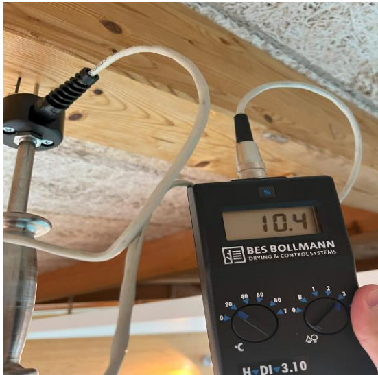
Bild 9 - Bild på fuktkvotskontroll i balk, under gränsvärde (balk vid rutschkana).
