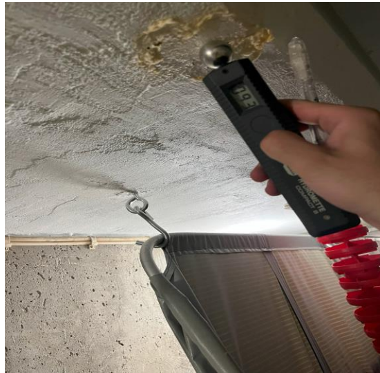
Bild 30 - Bild som visar på aktivt läckage från simhallsdelen i källarplan (högre värde än referensvärdet).
