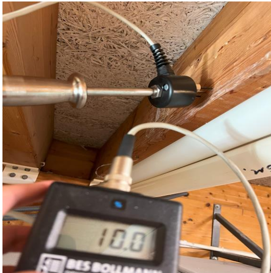
Bild 13 - Bild på fuktkvotskontroll i balk, under gränsvärde (vid kiosken). Här noterades mindre misstänkt mikrobiellpåväxt & missfärgningar.
