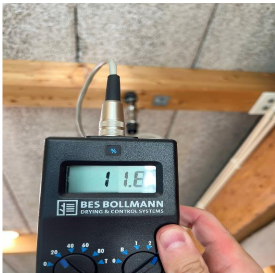
Bild 19 - Bild på fuktkvotkontroll i balk, under gränsvärde (ovanför ventilationsaggregatet). Här noterades mindre misstänkt mikrobiellpåväxt & missfärgningar.
