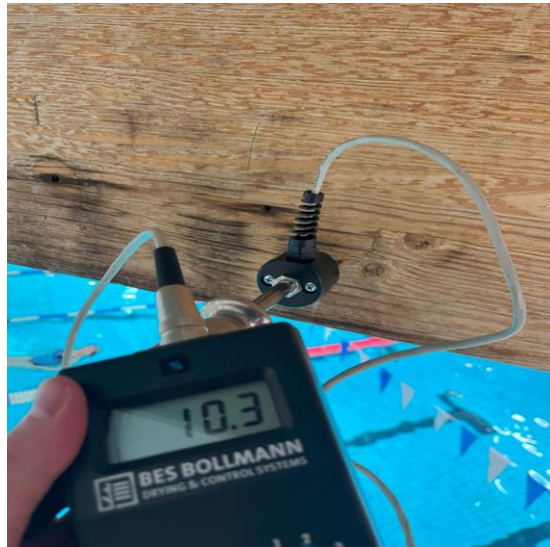
Bild 10 - Bild på fuktkvotskontroll i balk, under gränsvärde (balk vid rutschkana). Noterades missfärgningar.
