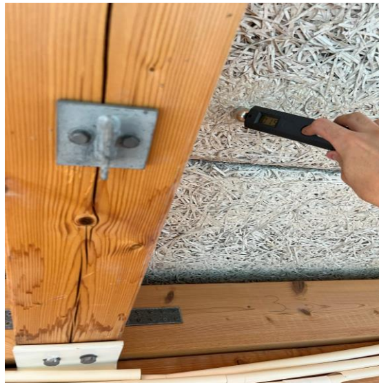
Bild 18 - Bild på indikation vid undertak/träullit (östra sidan, vänster om lekland), värde lika referensvärdet (påvisar ej förhöjda värden).
