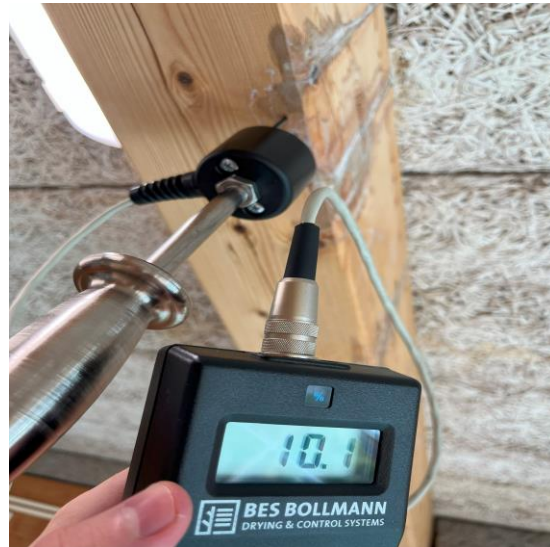
Bild 14 - Bild på fuktkvotskontroll i balk, under gränsvärde (östra sidan, vänster om lekland). Här noterades mindre misstänkt mikrobiellpåväxt & missfärgningar.
