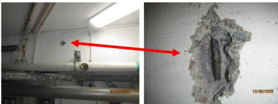
Bild som visar fältprov (KB 1) som utfördes med pH-indikator för analys av karbonatiseringsinträngningen. Den, ofärgade delen som syns i den högra bilden, påvisar hur djupt karbonatiseringen har trängt in i betongen vilket i det här fallet var ca 50 mm dvs hela provtagningsdjupet förbi armeringen. Mindre korrosionsutfällning konstaterades på armeringen.
