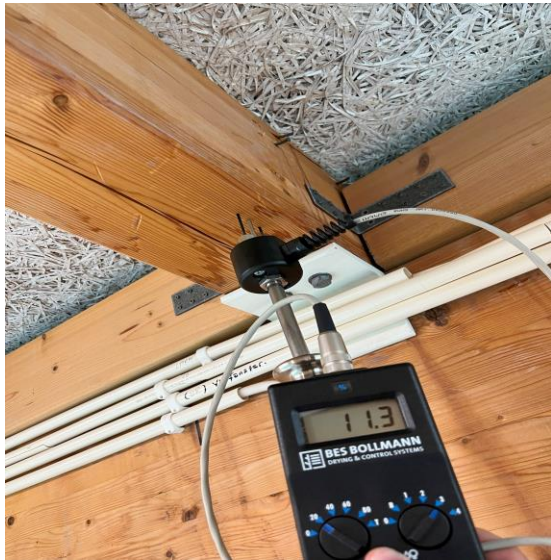
Bild 17 - Bild på fuktkvotkontroll i balk, under gränsvärde (östra sidan, vänster om lekland). Här noterades mindre misstänkt mikrobiellpåväxt & missfärgningar.
