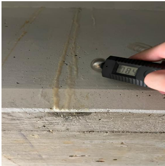
Bild 29 - Bild som visar på aktivt läckage från simhallsdelen i källarplan (högre värde än referensvärdet).
