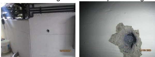
Foto 17. Fältprov (KB 2) som påvisar ett karbonatiseringsdjup på 29 mm. (Färgade delen visar på frisk betong och ofärgat djupet på karbonatiseringen)
