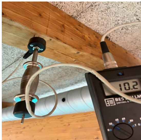
Bild 8 - Bild på fuktkvotskontroll i balk, under gränsvärde (balk vid rutschkana). Noterades missfäringar
