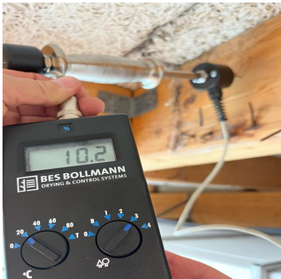
Bild 11 - Bild på fuktkvotskontroll i balk, under gränsvärde (vid kiosken).
