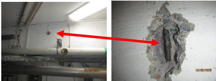
Foto 16. Fältprov (KB 1) utfördes med pH-indikator för analys av karbonatiseringsinträngningen. Den, ofärgade delen som syns i den högra bilden, påvisar hur djupt karbonatiseringen har trängt in i betongen vilket i det här fallet var ca 50 mm dvs hela provtagningsdjupet förbi armeringen. Mindre korrosionsutfällning konstaterades på armeringen.
